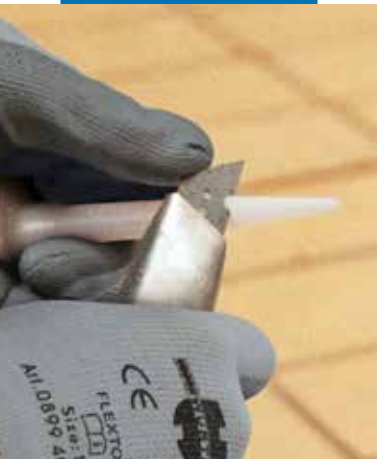
Przycinanie dyszy w zależności od wymiaru szczeliny
